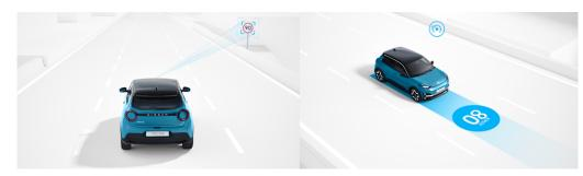
Durch die Verbindung mit dem Navigationssystem erkennt ProPILOT mit Navi-Link **Tempolimits**, **Kurvenverläufe** und **Ausfahrten** im Voraus und passt die Geschwindigkeit entsprechend automatisch an.
